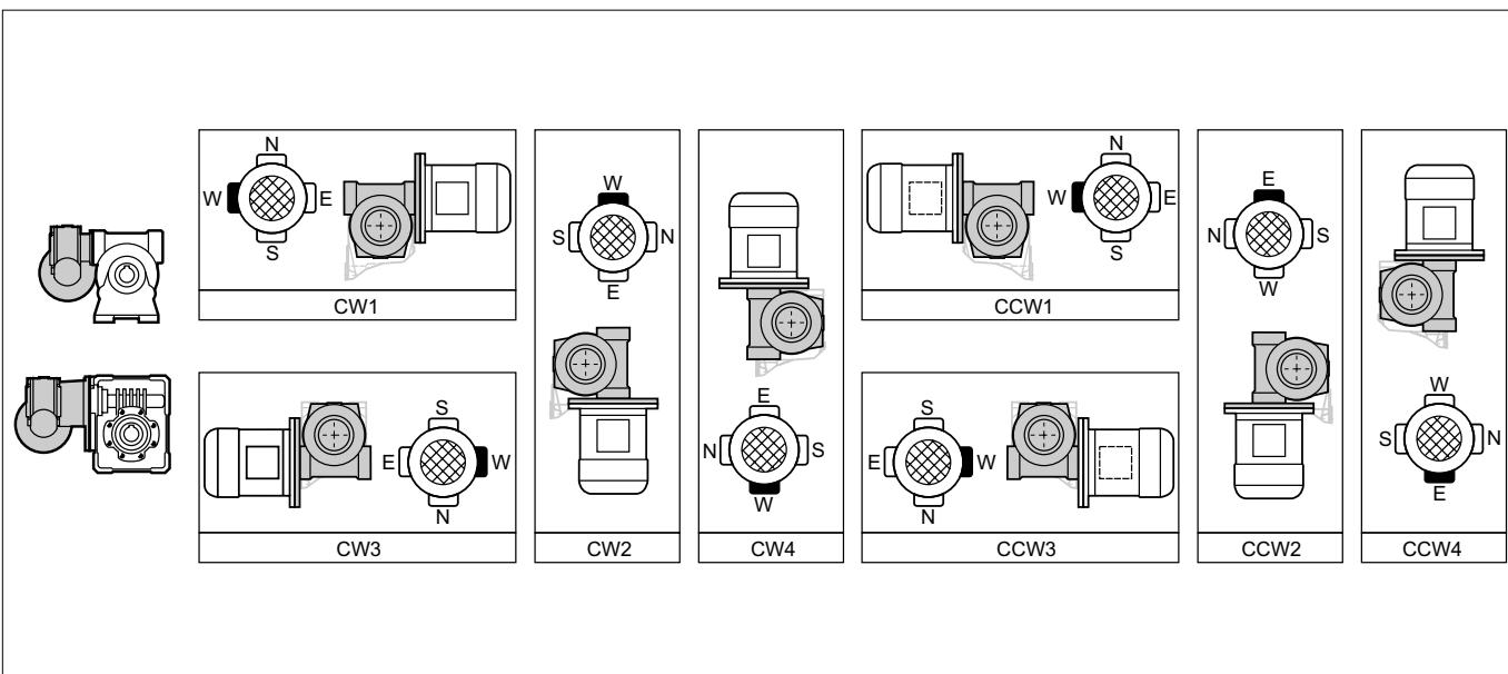
Nella configurazione HS (albero veloce cilindrico) è possibile ottenere tutte le esecuzioni di montaggio raffigurate.
